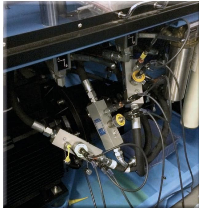
Die endgültige für das System von AMC Jets erarbeitete Lösung besteht aus einem tragbaren Datenlogger, vier Durchflussmessern mit fest installiertem Temperaturgeber, vier Druckwandlern, einem Partikelzähler und sämtlichen relevanten Steckern und Kabeln.
