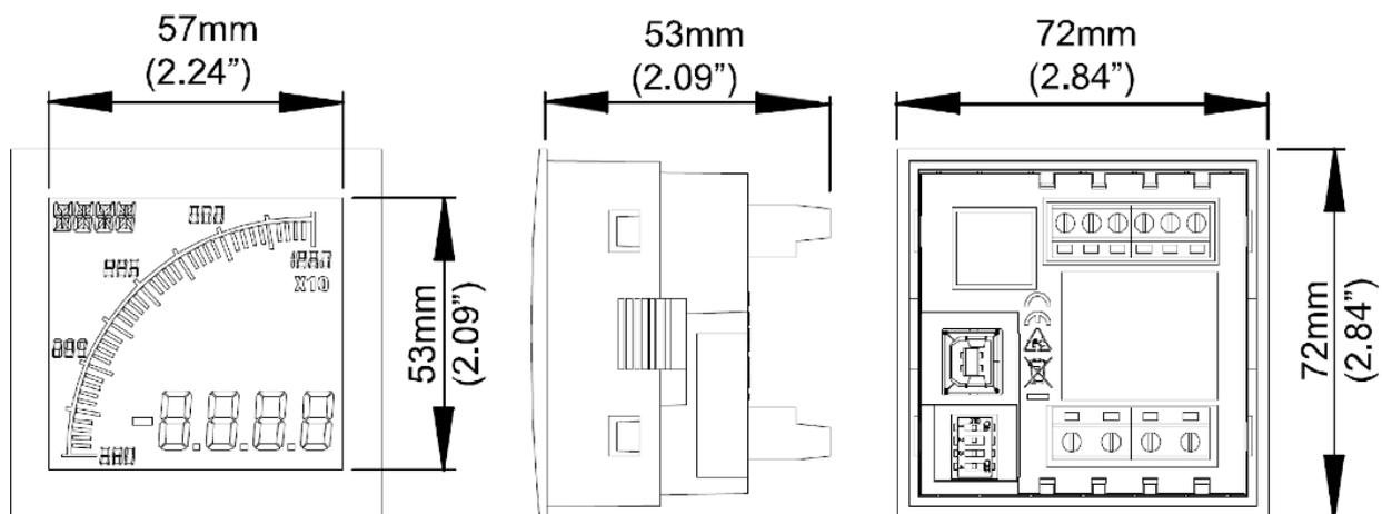
Aussparung 68 x 68 mm +0,7 -0 mm nach DIN43700/IEC61554
