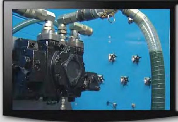
Faites tourner la pompe pour afficher les valeurs en temps réel (Débit, pression, température, vitesse et d'autres mesures venant de capteurs à sorties analogiques)
