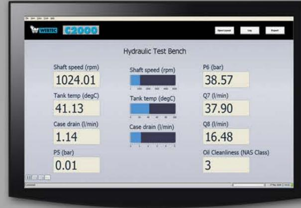
Use su propio procedimiento de ensayo para mostrar los valores en tiempo real y registre los resultados pulsando una tecla.
