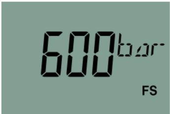
Indicación del área de medición (FS) en bar.
