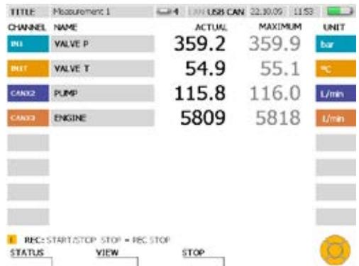
**i** Die laufende Messung wird durch das Blinken von REC in der Informationszeile angezeigt.
