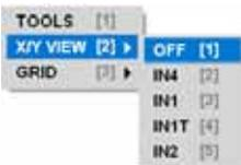
Untermenü X/Y View: Sensoren als Datenquelle für die x- und die y-Achse
