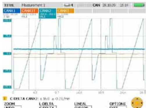
Bewegen der rechten Cursor-Linie mit den Pfeiltasten. Verschieben Sie die Linie, bis der zweite Messwert für die Bestimmung der Differenz erreicht ist.
