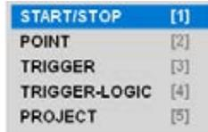
Auswählen des Menüs TRIGGER und Eintragen der Aufnahmedauer (hier: 1 Stunde, 23 Minuten).
