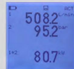
Canal calculé indiquant la puissance hydraulique
