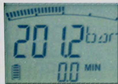
HPM110 indiquant la pression réelle sous forme de valeur numérique et sur le bargraphe
