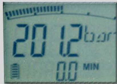
HPM110 mit Istdruck als numerischen Wert und auf Balkendiagramm
