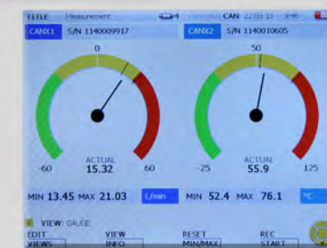
HPM6000 mostrando dos diales grandes (pulse hacia abajo para ver valores adicionales)
