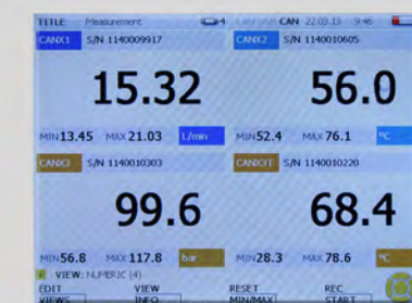
HPM6000 mostrando dos diales grandes (pulse hacia abajo para ver valores adicionales)
