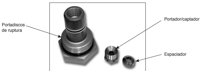
Con los discos de ruptura nuevos (uno a cada lado del espaciador del disco de ruptura: véase el paso 3), inserte uno en el portador/captador, seguido del espaciador de disco de ruptura y luego el segundo disco de ruptura. Enrosque el portadiscos de ruptura/captador de vuelta en la parte superior del cuerpo del portador y apriete a un par de torsión de 55 Nm.
