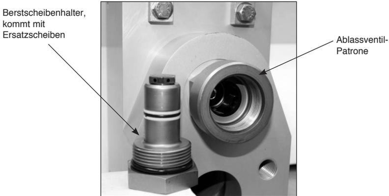
Entfernen Sie den Berstscheibenhalterfänger mit einem geeigneten Steckschlüssel und entnehmen Sie die Berstscheiben und Abstandshalter, wie in Schritt 2 dargestellt. Geborstene Scheiben wegwerfen!
