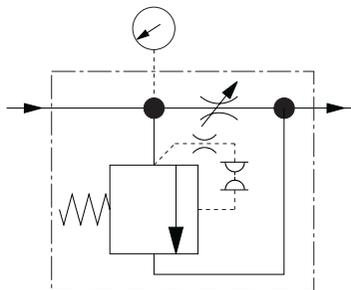
**Hinweis:** Es gibt nur einen sehr eingeschränkten Weg durch das Ventil für rückwärtigen Durchfluss - die Berstscheiben würden via der Pilot-Auslassleitung ablassen, aber das Bypassventil wird nicht funktionieren.
