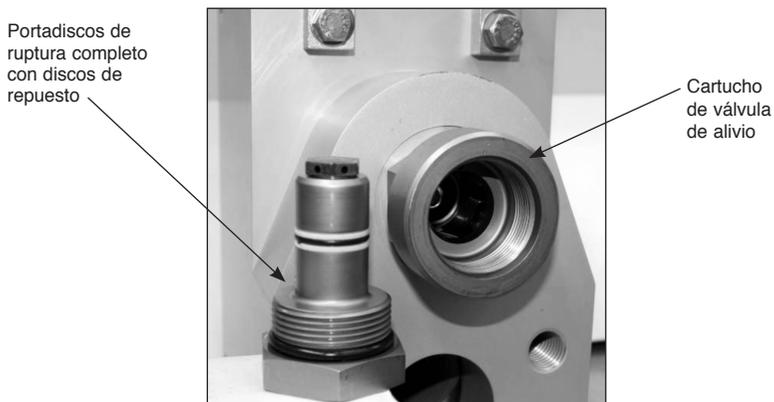
Retire el portadiscos de ruptura/captador con una llave de cubo apta y extraiga los discos de ruptura y el separador como se muestra en el paso 2. ¡Deseche los discos rotos!
