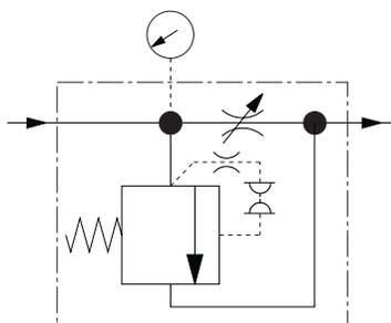
**Note:** Dans le sens inverse, il n'y a qu'un faible orifice très restrictif; les pastilles seront percées via l'échappement du pilote, mais le tiroir du bypass ne s'actionnera pas.
