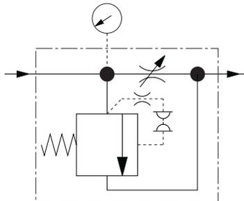
**Nota:** Sólo hay una vía altamente restrictiva a través de la válvula para el flujo inverso: los discos de ruptura de seguridad perderán vía la canalización de escape auxiliar pero la válvula de derivación no operará.
