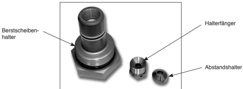
Verwenden Sie neue Berstscheiben (eine auf jeder Seite des Abstandshalters - sehen Sie Schritt 3) und legen Sie eine in den Halterfänger ein, gefolgt vom Abstandshalter und dann die zweite Scheibe einlegen. Schrauben Sie den Halterfänger wieder in den oberen Teil des Berstscheibenhalters ein und ziehen Sie bis zu einem Drehmoment von 55 Nm (40 lb/ft) an.
