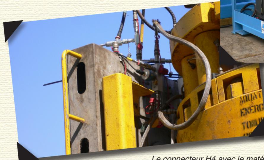
Le connecteur H4 avec le matériel d'essai branché
