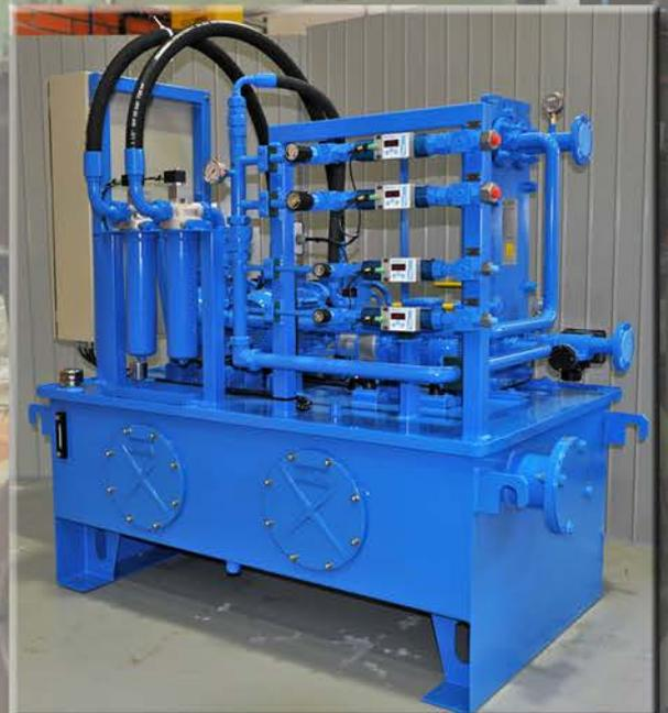
El problema que trajo del Sr Cardoso al stand de Webtec giraba en torno al monitoreo del fluido hidráulico suministrado mediante los grupos hidráulicos que diseña y proporciona Izda a grandes plantas industriales tales como las de laminación de acero y las usinas eléctricas. El fluido tiene la finalidad de enfriar y lubricar los rodamientos de los grandes motores hidráulicos y generadores.
