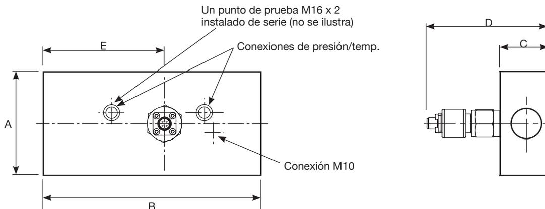
Nota: LT15 tiene una sola conexión de presión/temp.
